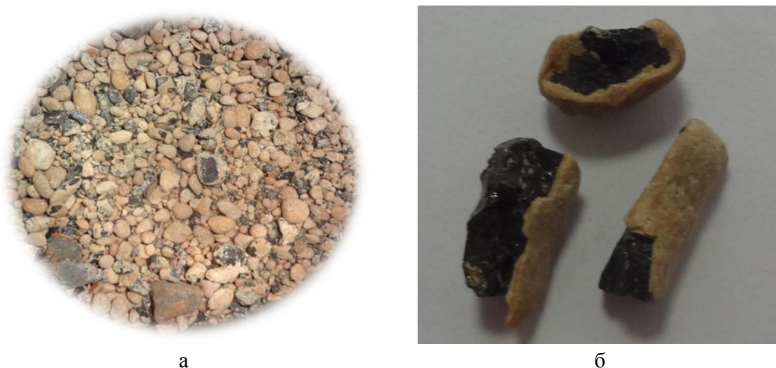
Рисунок 1. Нарост отложений на затворе аванкамеры циркуляционно-насосной станции Набережно Челнинской ТЭЦ: а – шарообразные отложения белого цвета, б – расколотые шарообразные отложения белого цвета
