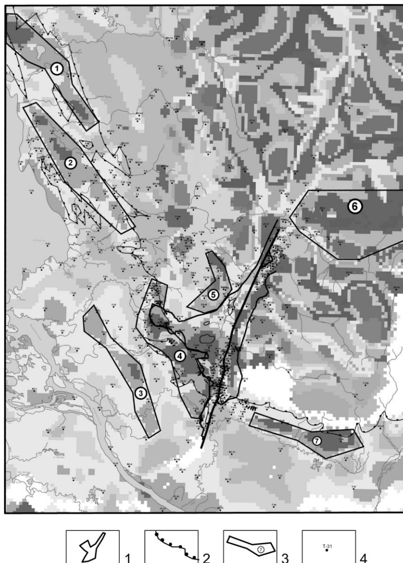
Рис. 1. Результаты прогнозной классификации геофизических полей (КОСКАД-3D): 1 – контур рудоносной инрузии; 2 – граница развития трапповых образований; 3 – выделенные перспективные участки; 4 – скважины, их номера
