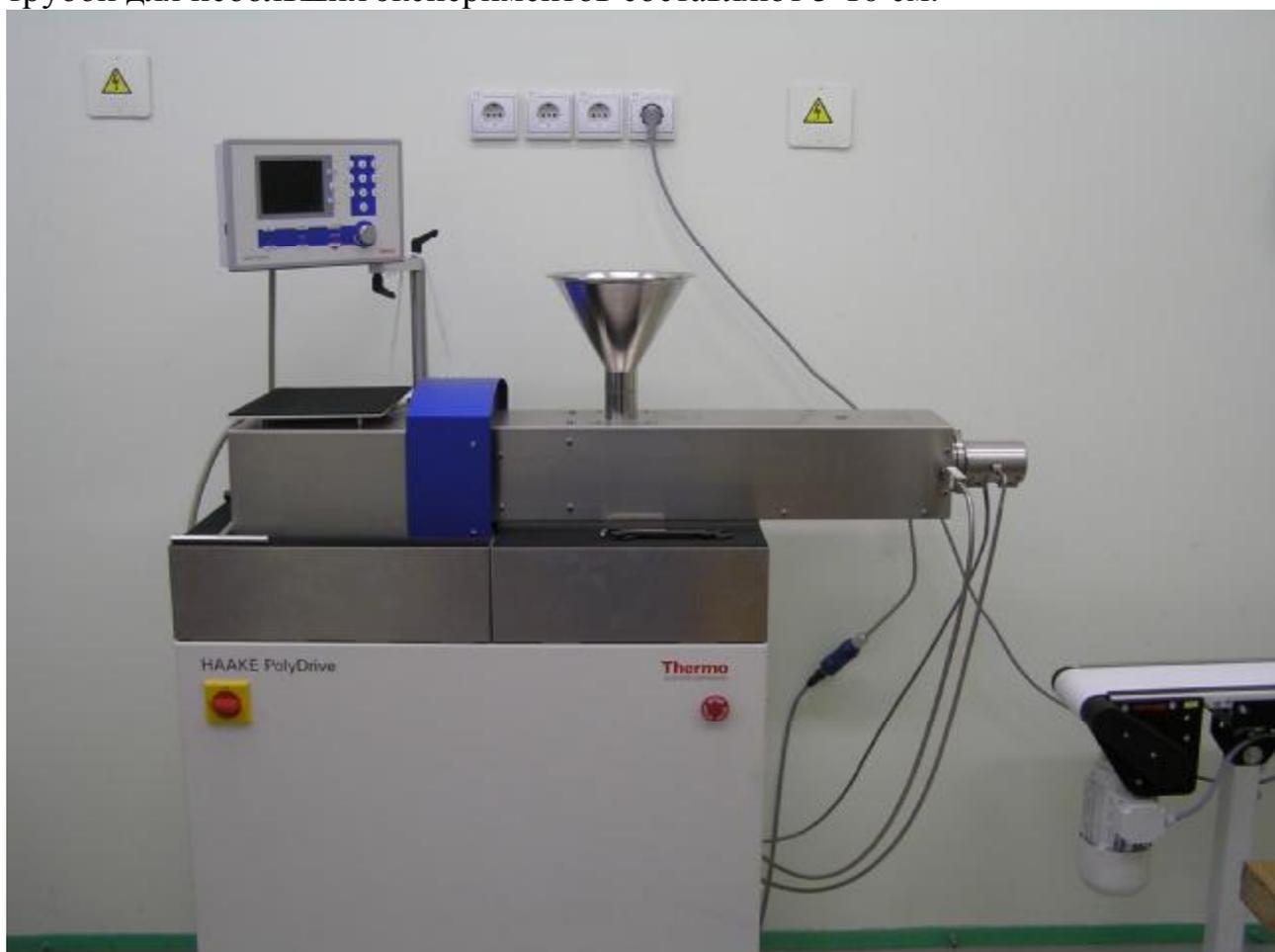
Рис. 2 Экструдер HAAKE PolyDrive R252
