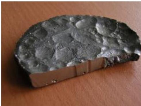
Рис. 1. Образец чугуна, полученного из шлама
