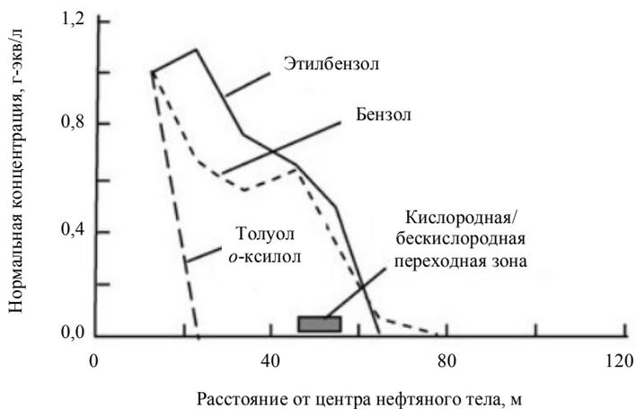
Рис. 12.4. Концентрации в подземных водах выбранных соединений алкилбензола у северной залежи, демонстрирующие влияние селективной структурно-зависимой биodeградации углеводородных соединений на их присутствие в шлейфе [83]
