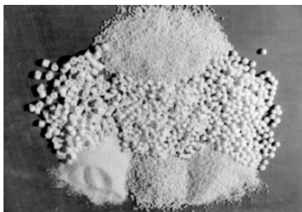
Рис. 3.6. Гранулированный оксид алюминия, полученный методом углеводородно-аммиачного формования
