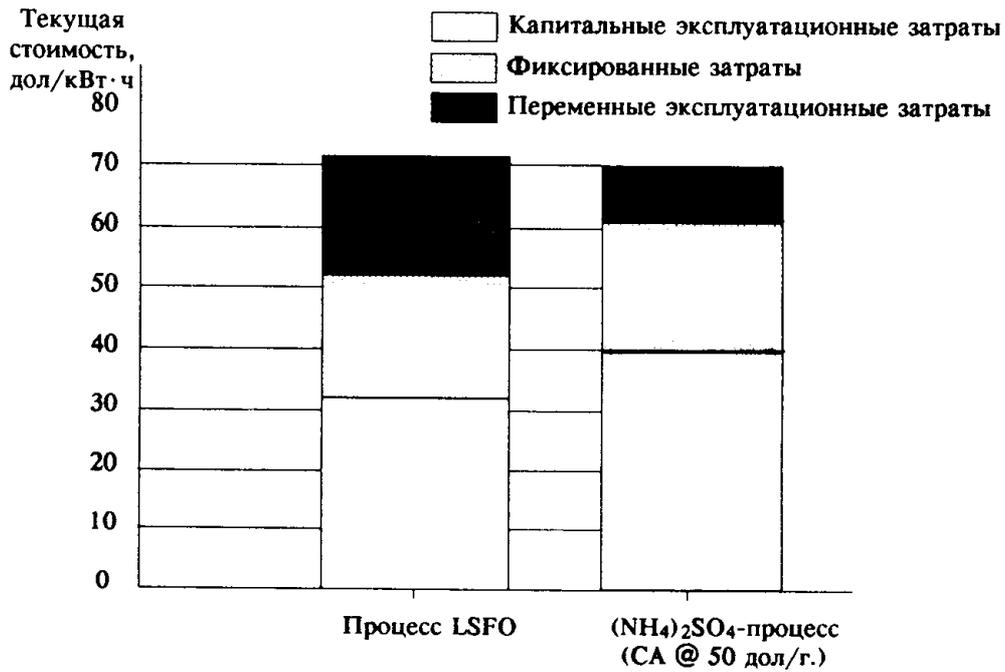
Рис. 2.6. Сравнение стоимости сульфатно-аммонийного процесса (FGD) с известняковым (LSFO) для угля с 2,6% серы
