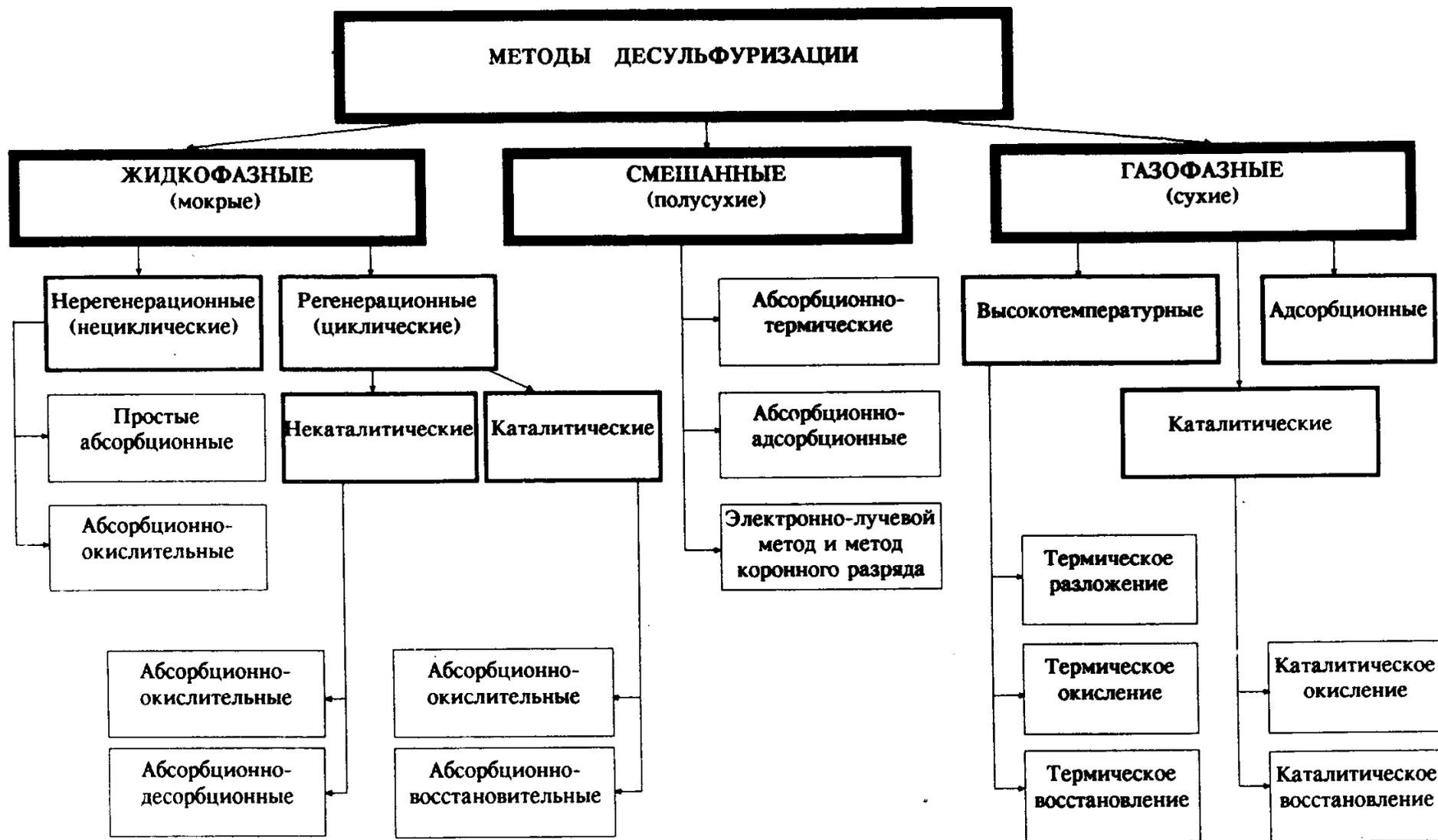
Рис. 2.1. Классификационная схема процессов десульфуризации отходящих промышленных газов
