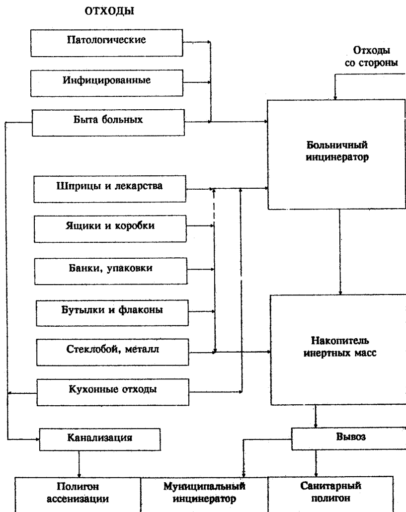
Рис. 1.1. Общая схема организации сбора и ликвидации отходов и мусора крупных больниц, госпиталей и патологоанатомических учреждений [7]. Сплошными линиями показаны нормативные пути потока отходов; штриховой стрелкой - возможный путь переработки отходов с сокращением объема
