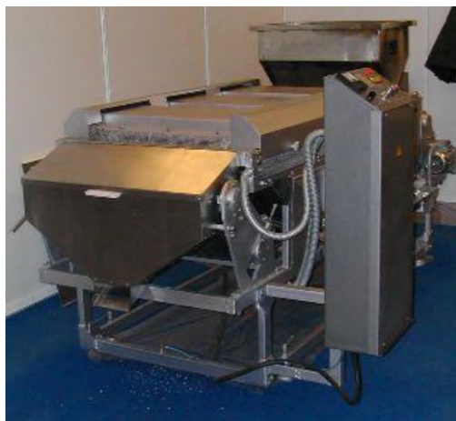
Фото 1. Установка для термообработки зернового сырья УТЗ-4Ш
