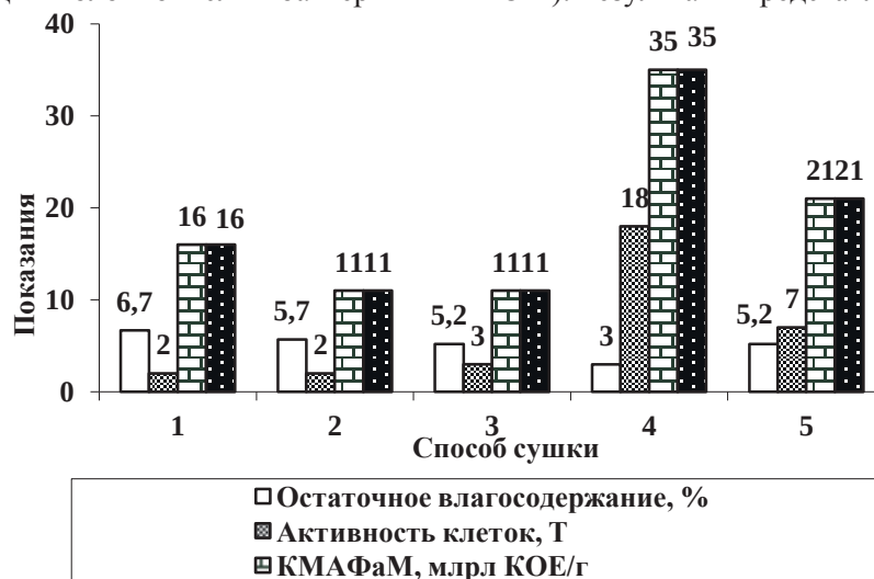
Рис. 1 – Оценка эффективности различных видов обезвоживания: 1 – низкотемпературная вакуумная сушка; 2 – сублимационная сушка с само замораживанием продукта; 3 – сублимационная сушка с замораживанием при температуре -50 °С; 4 – замораживание и хранение в жидком азоте, -196 °С; 5 – сублимационная сушка с контактным замораживанием сырья, -18 °С.
