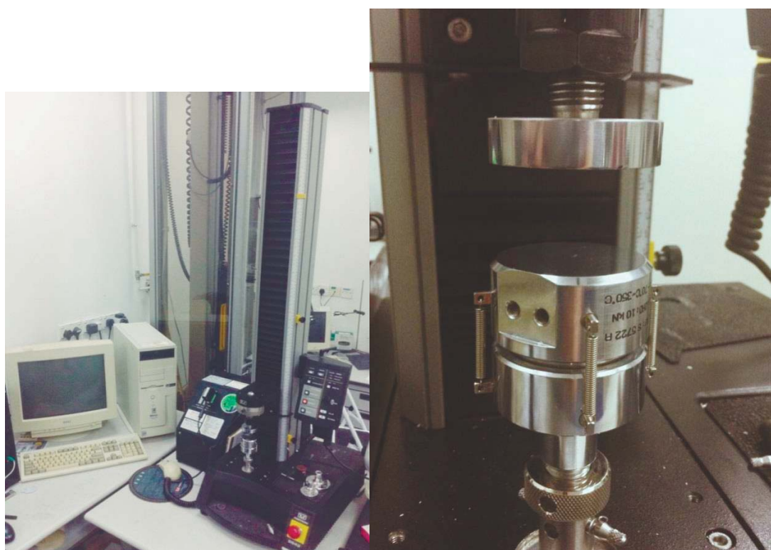
Рис. 2 – Установка на сжатие Instron 5543(слева), датчик силы сжатия (справа)
