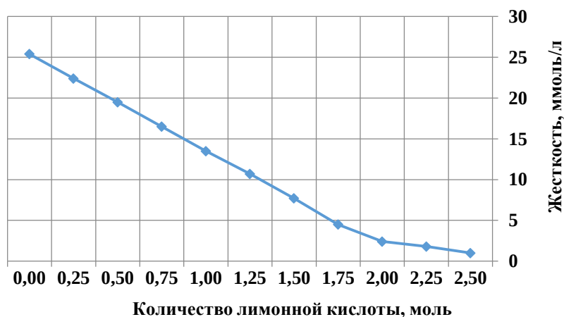
Рис. 1 – Зависимость жесткости раствора от соотношения \text{Ca}^{2+} к лимонной кислоте
