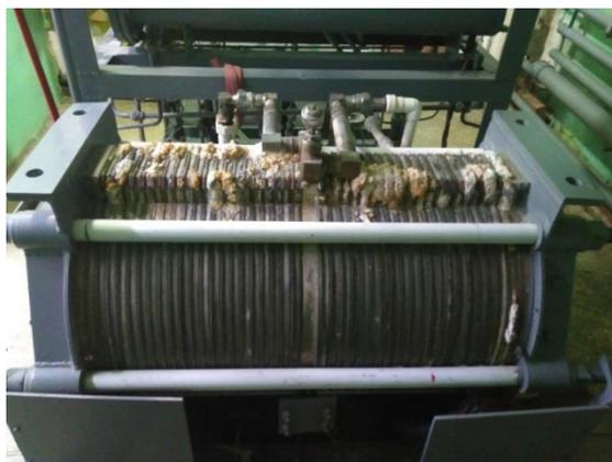
Рисунок 1. Электролизер установки «КРАБ»
