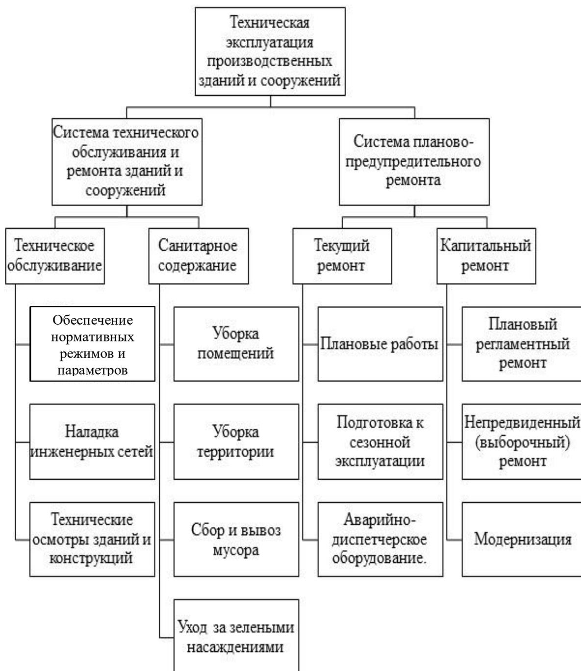
Рис. 2. Система эксплуатации производственных зданий и сооружений
