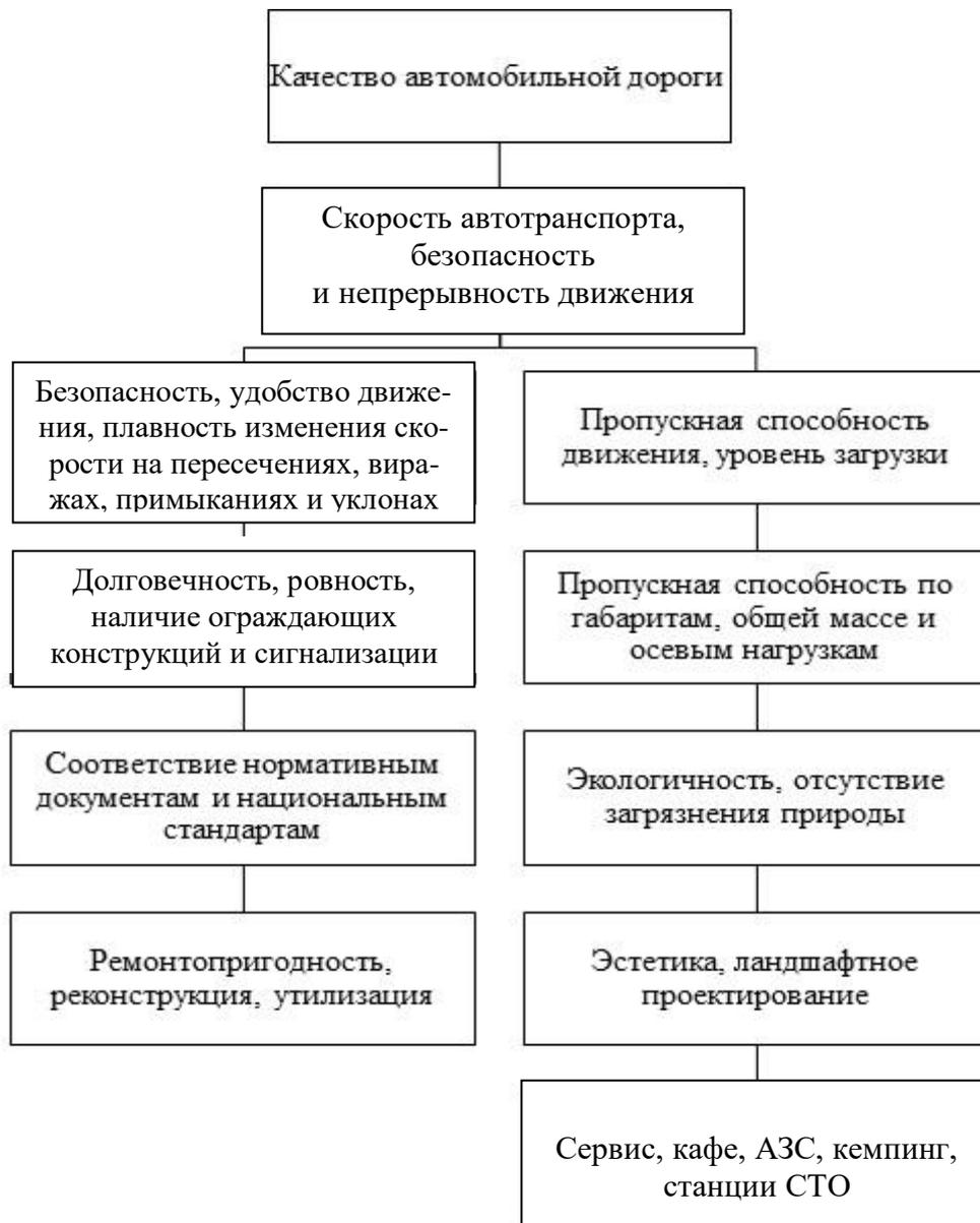
Рис. 1. Схема составляющих качества автомобильных дорог
