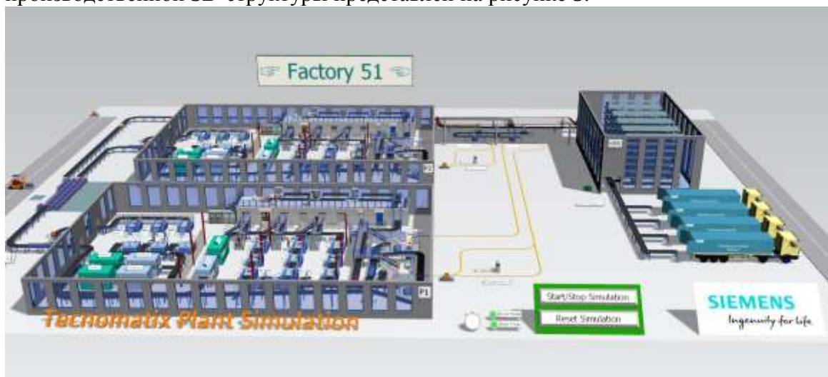
Рисунок 5 – Пример производственной 3D-структуры, сформированной в модуле Plant Simulation [13]
