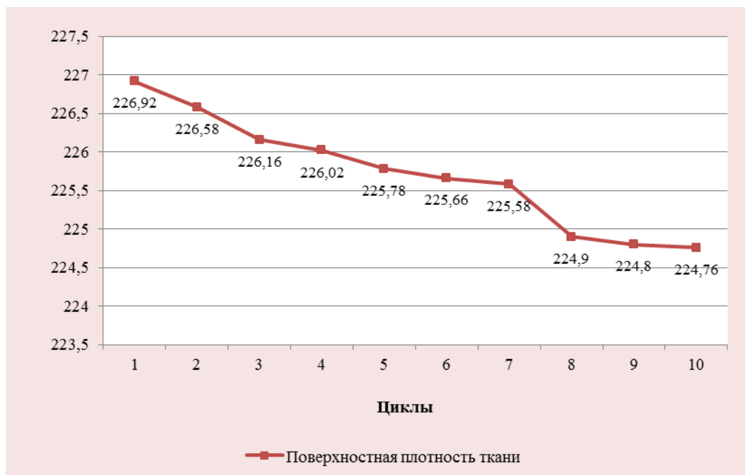
Рисунок 4- Изменение поверхностной плотности ткани в течение 10 циклов инсоляции
