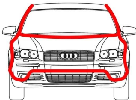
Рисунок 3 - Схема расположения каркаса спереди
