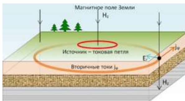
Рисунок 1 – Появление холловской напряжённости электрического поля
