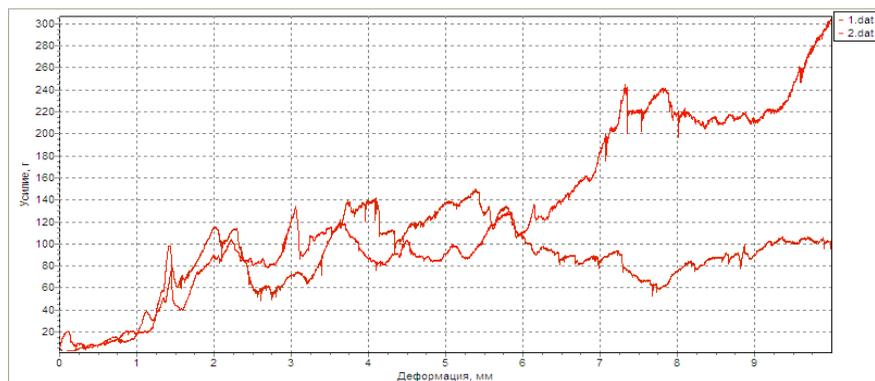
Рис. 1. Изменение усилия нагружения на индекторе «Игла» в зависимости от глубины её внедрения в экструзионный продукт; 1 – экструзионный продукт из зерна сорта тритикале Трибун 2 – экструзионный продукт из зерна сорта Немчиновский 56
