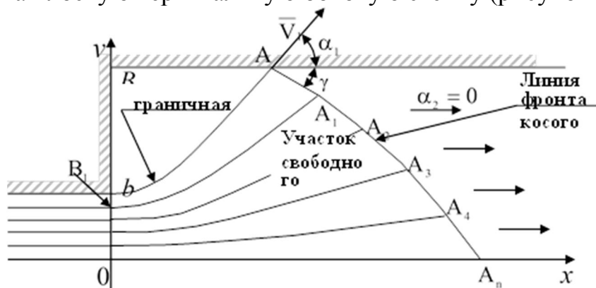
Рисунок 1 – Схема набегания граничной линии тока на боковую стенку русла и образование косого гидравлического прыжка
