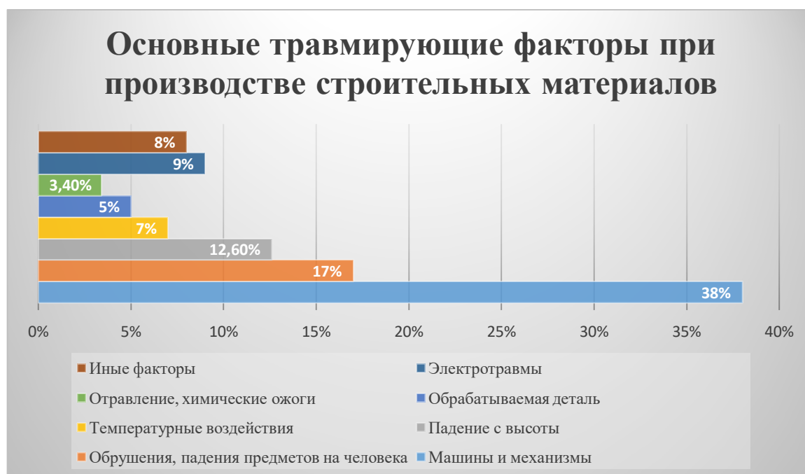
Рисунок 3 – Основные травмирующие факторы при производстве строительных материалов
