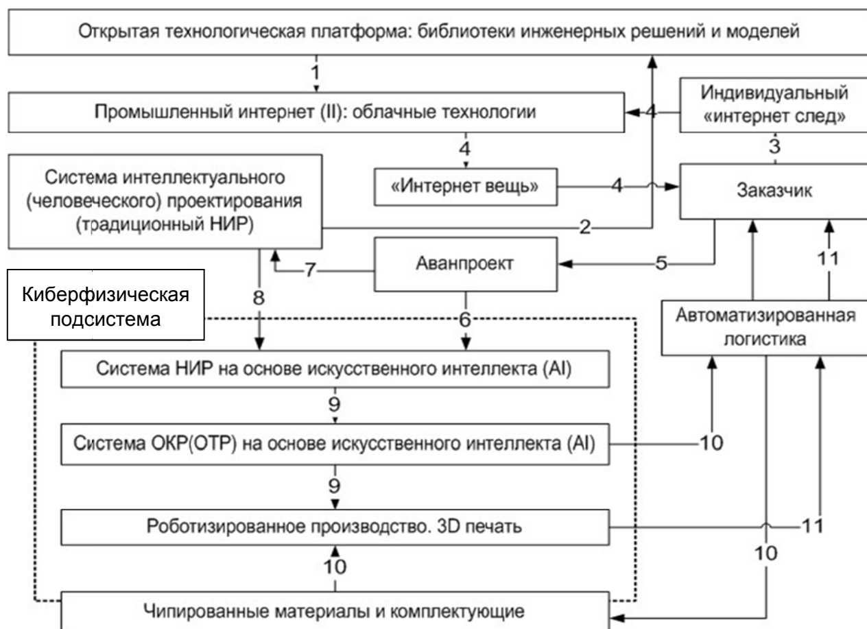
Рис. 1.6. Перспективный алгоритм процессов проектирования и производства промышленного предприятия на платформе концепции «Промышленность 4.0». Связи раскрыты в табл. 1.10 16
