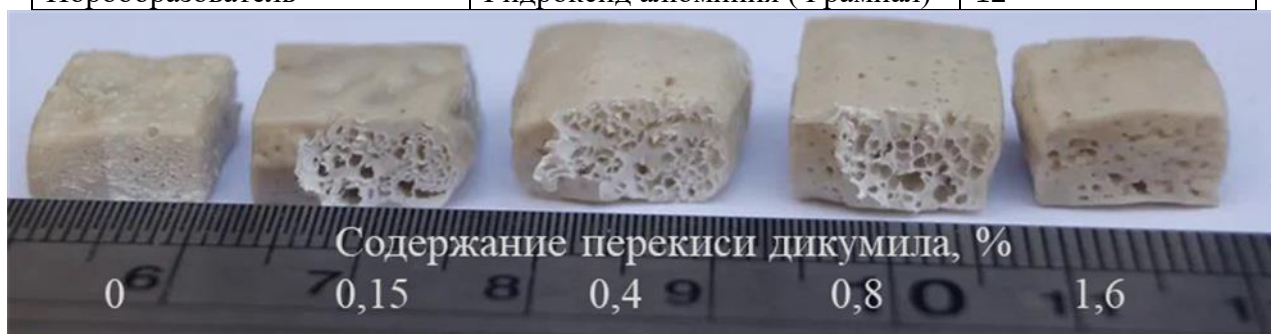
Рис. 1. Образцы материала по рецептуре из табл. 1, вспененные в течение 5 мин при 170°C
