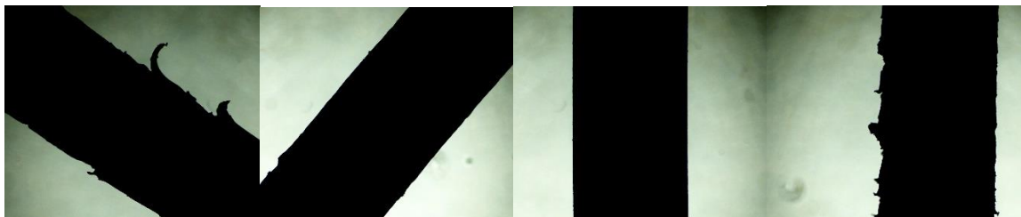
Рис. 1. Микрофотографии экструдатов полученных при одинаковых условиях экструзии из образцов 1, 2, 3 и 4 (в порядке слева направо).
