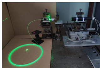
Рис.1. Фотография бухты светящегося КП-ОВ/Tefzel/200 мкм длиной 60 м при его засветке излучением лазера LG Laser 303 (длина волны излучения – 532 нм). Диаметр бухты – 190 мм; ввод излучения в волокно – через объектив \times 10 , 0.4.
