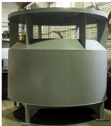
Рисунок 2 – Схема шумоглушителя сброса пара/газа для уровня звука 95–120 дБ
