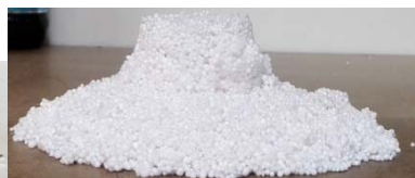
Рис. 11. Гранулит ИСУ-6Т (АС – г. Кемерово)
