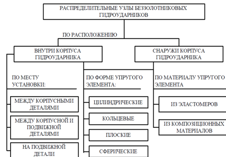
Рис. 1. Классификация распределительных узлов беззолотниковых гидроударников
