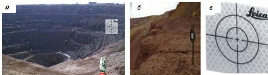
Рис. 2. Профильные линии станции и средства наблюдения: а, б – расположение рабочих реперов на уступах; в – вид наблюдательной марки
