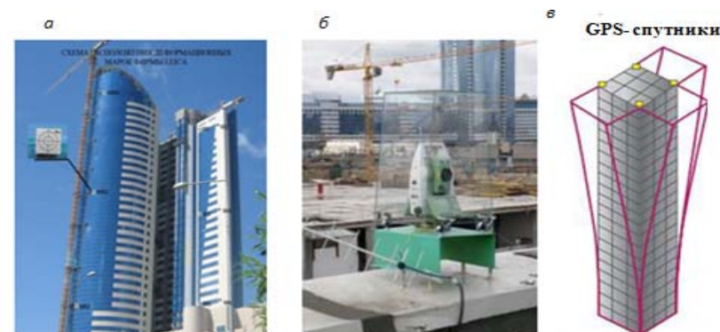
Рис. 1. Расположение контрольных марок на объекте (а); мониторинг здания с применением роботизированного электронного тахеометра(б); общая схема GPS-мониторинг ветрового воздействия на высотное здание (в)
