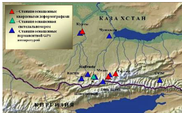
Рис.1. Схема размещения станций, оснащенных деформографами, светодальномерами и GPS приемниками
