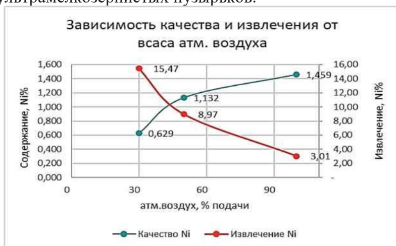
Рисунок 3. Работа аэратора типа I. Влияние атмосферного воздуха на качество и извлечение
