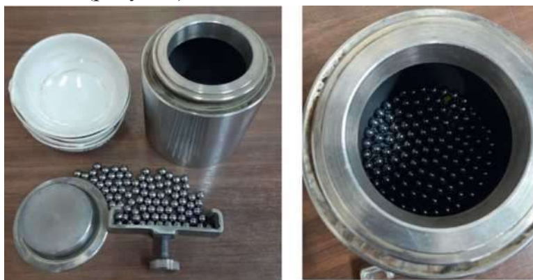
Рисунок. Испытательный барабан с комплектом стальных шаров
