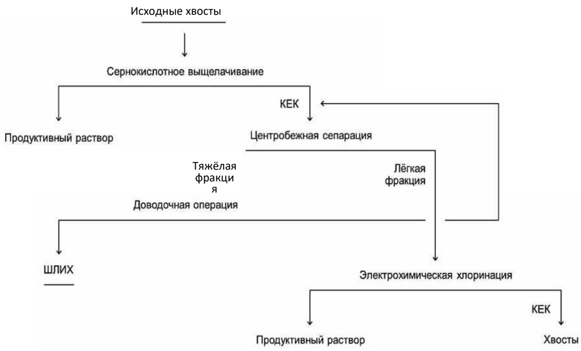
Рисунок 1. Схема сернокислотного выщелачивания и электрохимической хлоринации
