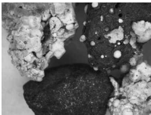
Рисунок 2. Комковидные агрегаты минеральных фаз различного состава в крупной фракции смета глинозема
