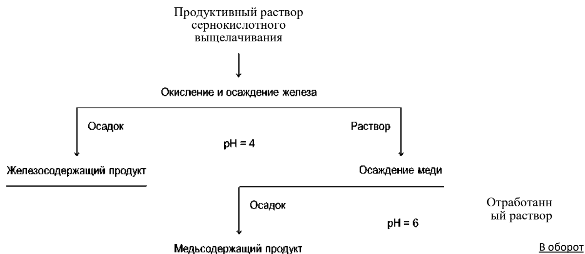
Рисунок 2. Схема переработки продуктивного раствора сернокислотного выщелачивания
