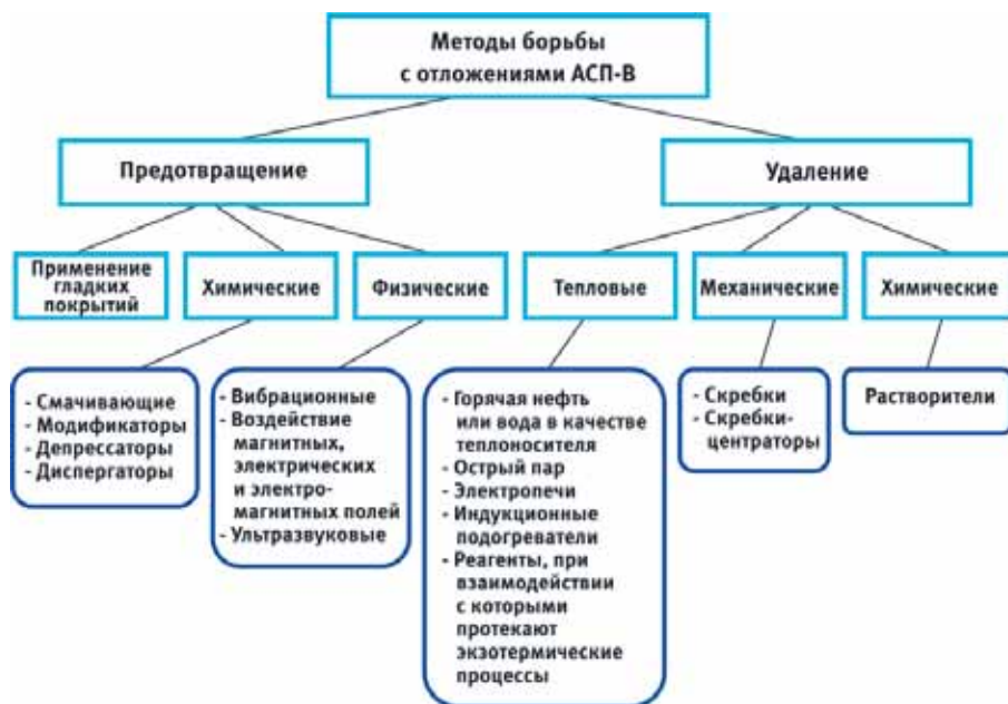
Рис. 2. Схема классификации методов борьбы с отложениями АСП-В.
