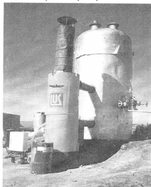
Рис. 3. Подогреватель воды пульсирующего горения (схема б).
