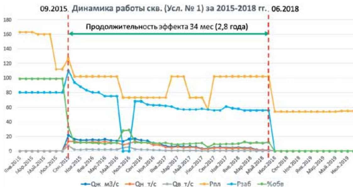
Рис. 4. Пример работы скважины НГДУ АН (I тип пород).
