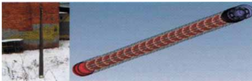
Рис. 1. Устройство физико-химической обработки скважины для синтеза оксида.
