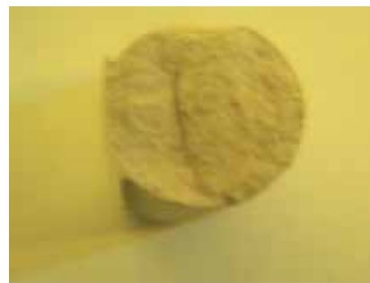
Рис. 1. Трещина после гидроудара.
