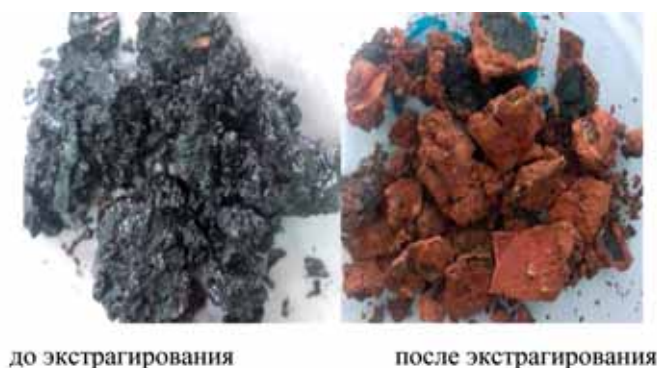
Рис. 1. Внешний вид отложений неорганических солей.
