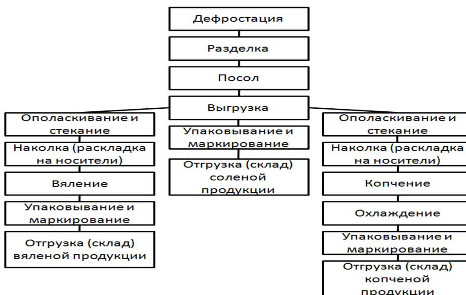
Рисунок. Схема производства рыбной продукции
