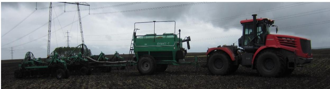
Рисунок. Посевной агрегат «Кировец» К-744РЗ+ПК-9,7 «Кузбасс-Т»
