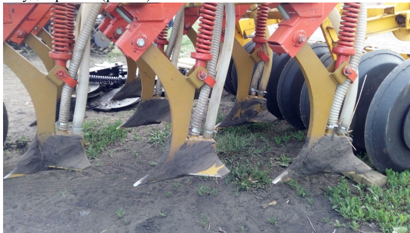
Рис. 1. Сошник для разноглубинного способа посева и внесения минеральных удобрений
