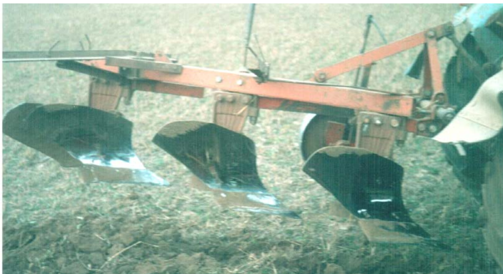
Рисунок 4. Экспериментальный плуг на базе ПН 3-35 с увеличенной шириной третьего корпуса и уширенными лемехами передних корпусов (без смещения заднего корпуса влево)
