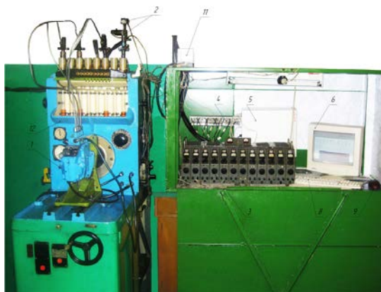
Рисунок 1 – Общий вид экспериментальной установки исследования процесса топливоподачи: 1 – ТНВД; 2 – датчики: тензометрический давления в топливопроводе у форсунки, индуктивный хода клапана форсунки,
