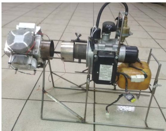
Рисунок 2 а) внешний вид усовершенствованного ГГГ б) процесс снятия температурных режимов работы с помощью АЦП модуля ZET-210
