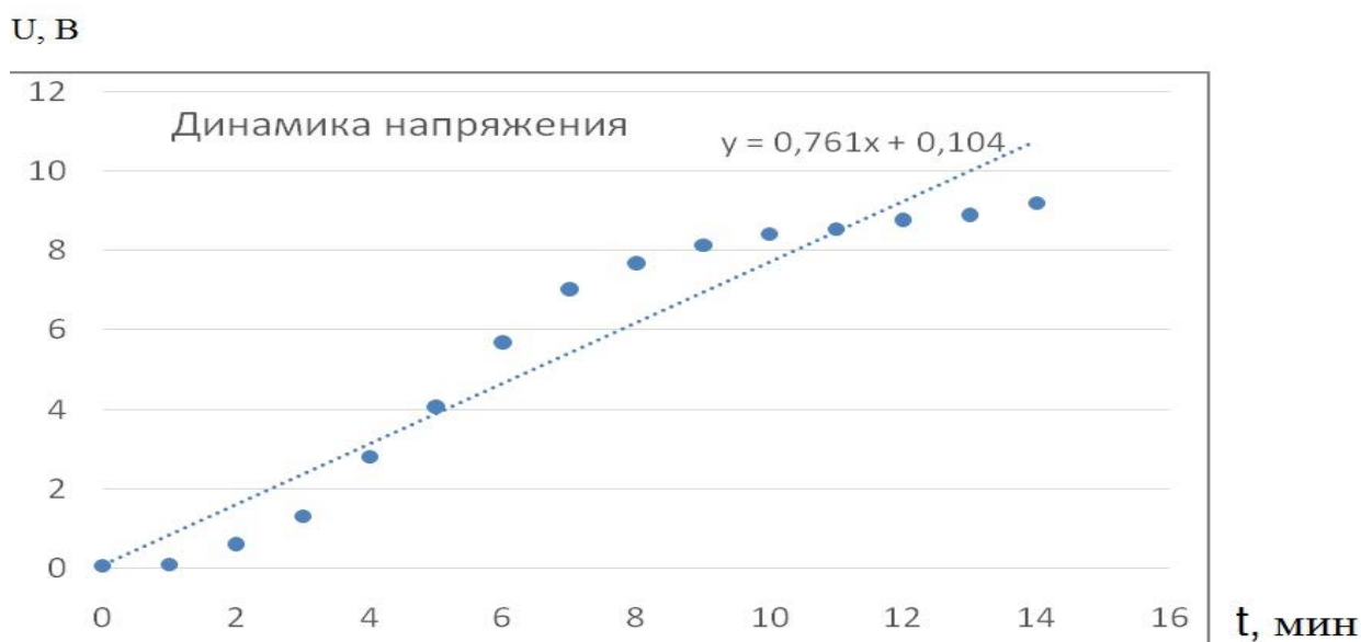
Рисунок 3 Динамика напряжения с каскада ТГМ
