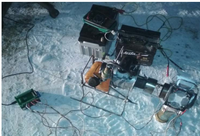
Рисунок 2 а) внешний вид усовершенствованного ГГГ б) процесс снятия температурных режимов работы с помощью АЦП модуля ZET-210
