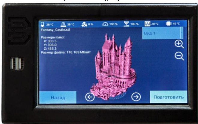
Рисунок. Панель управления 3D-принтера «Эрзя 3D SpaceBot»
