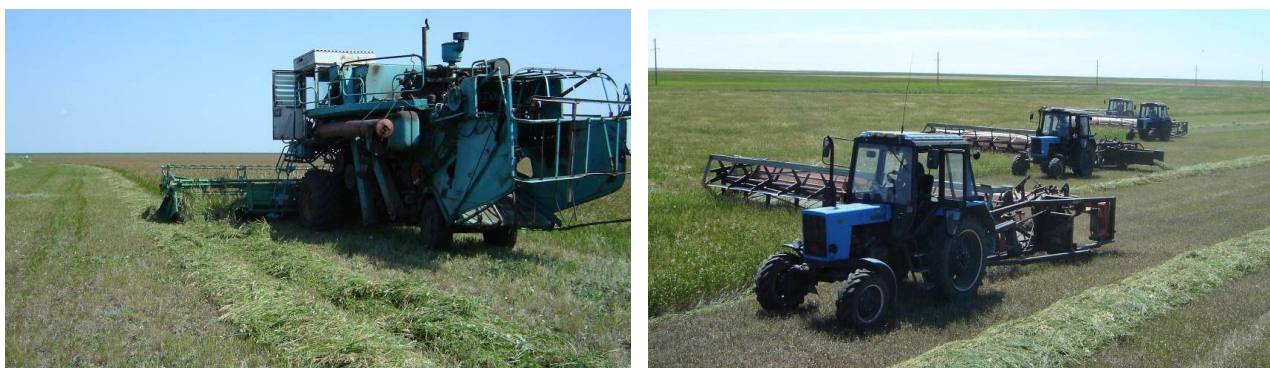
Рисунок 2 – Формирование сдвоенного валка жатками ЖВН-6 и ЖВП-9,1
