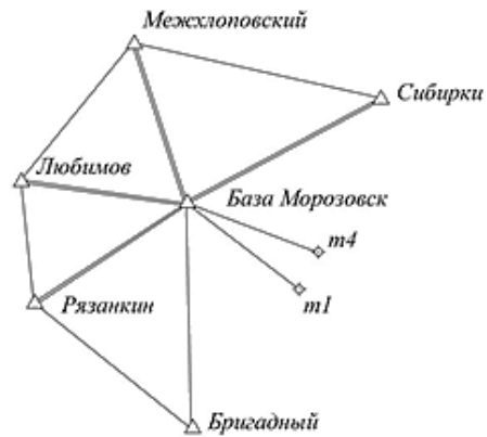
Рисунок 4 – Схема планово-высотного обоснования исходных пунктов
