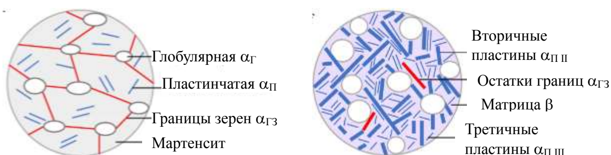
Рис. 1 – Схематичное представление разнообразия морфологии \alpha -фазы в титановых сплавах по [17]
