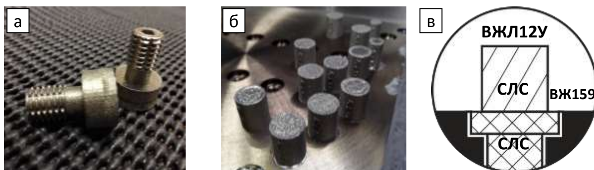
Рис. 2 – Внешний вид резьбовых закладных элементов, изготовленных методом СЛС из сплава ВЖ159 (а), синтезированных образцов из сплава ВЖЛ12У (б) и схема процесса (в)
