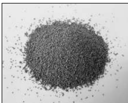
Рис. 1 – Гранулы дисперсно-упрочненного металлического композиционного материала на основе алюминиевого сплава, полученные механическим легированием
