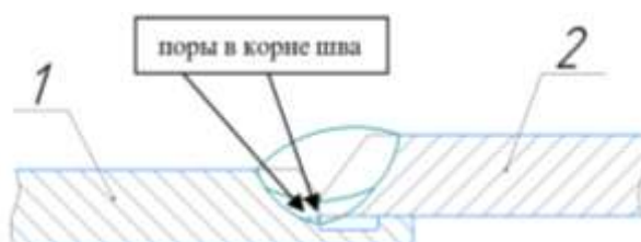
Рис. 3 – Схема расположения дефектов в виде одиночных пор в корне шва при условии c = b - a
