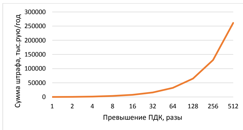
Рис. 1 – График изменения суммы штрафов в зависимости от превышения ПДК в сточной воде железа и этиленгликоля
