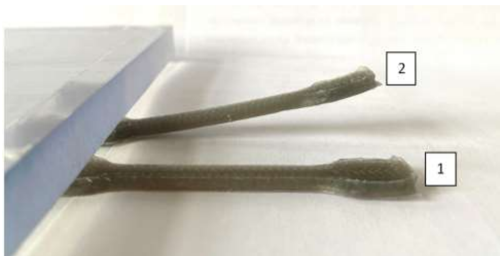
Рис. 4 – Фотографии образцов, полученных при температуре сопла FDM-принтера 260 °С (1) и 200 °С (2)
