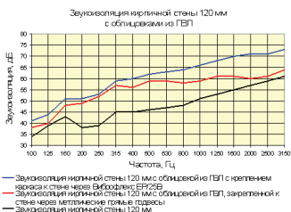
Рис.6. График эффективности звукопоглощения применяемых панелей.
