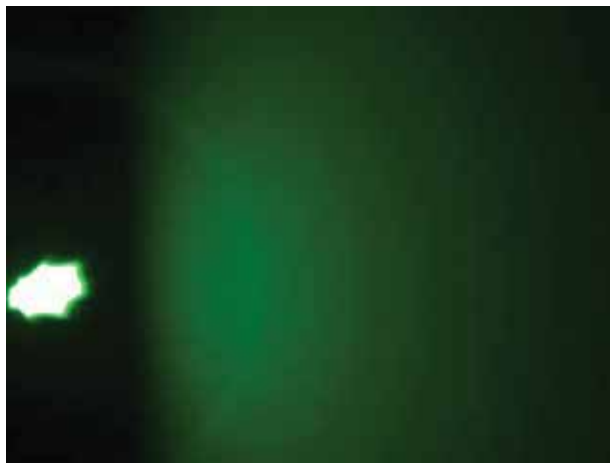
Рис. 1. Картина малоугловой дифракции быстрых электронов от приповерхностных слоев коммерческих подложек \text{SrLaGaO}_4 , ориентации (100).
