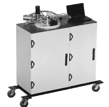
Рис. 1. Рентгеновский аппарат на основе X-пинча для исследований в области медицины и биологии.
