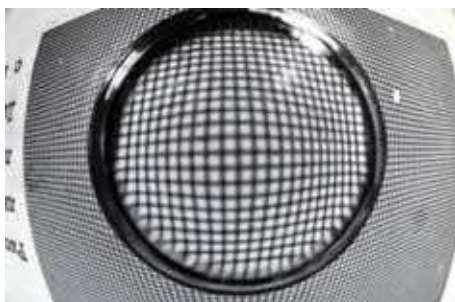
Рис. 2. Фотография миниатюрной линзы из кристаллического \text{MgF}_2 на опорной сетке с периодом 100 мкм, радиус кривизны линзы 2.0 мм.
