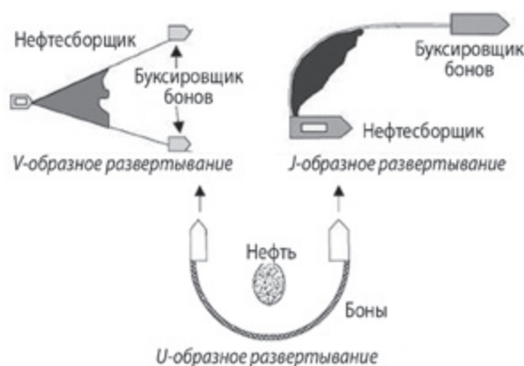
Рис. 1. Схемы развертывания боновых заграждений
