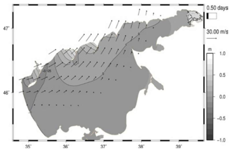
Рис. 5. Уровень моря (м) и скорость ветра для траектории Т2 при t = 12 ч
