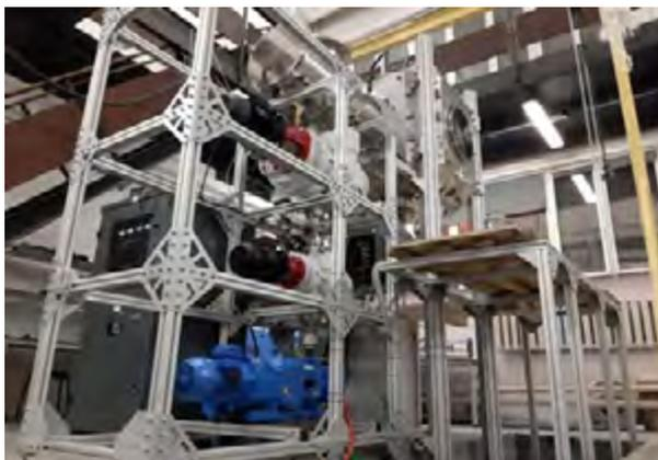
**Рис. 21.** Стенд «Испаритель»
