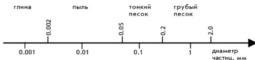
Рис. 2. Фракции гранулометрических частиц (по А. Аттербергу)
