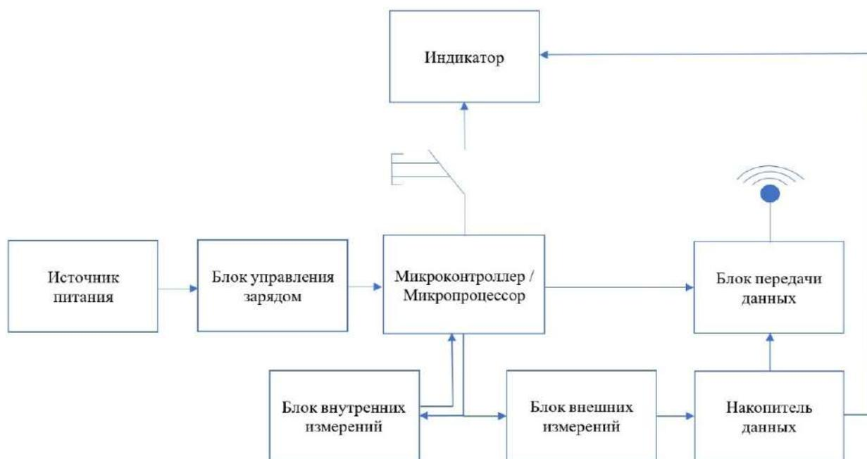
Рис. 2. Структурная схема устройства
