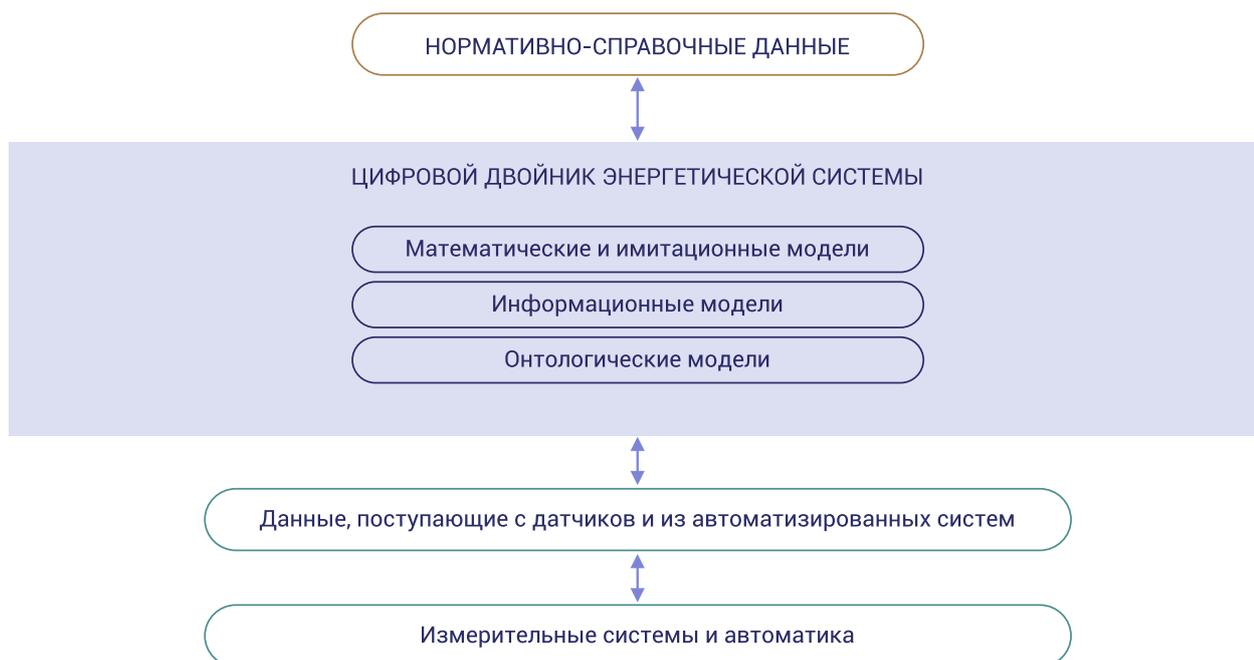
Обобщенная архитектура цифрового двойника энергетических объектов и систем на основе онтологического подхода [19, 26] имеет вид, представленный на рис. 7.
