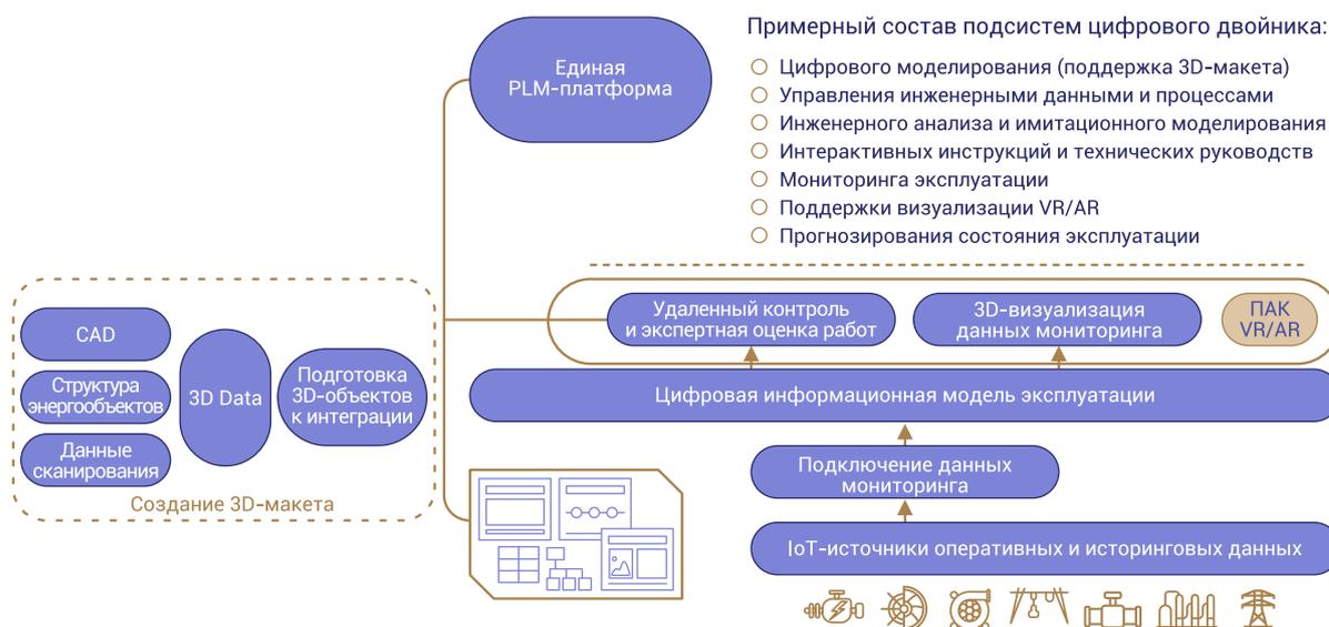
В ЦД объединяются инструменты для создания цифровой 3D-модели объекта/системы, разрабатываемой с помощью системы инженерного проектирования (CAD), информационно-телекоммуникационная система на базе промышленного Интернета вещей и интегрированные математические модели для отслеживания поведения и оптимизации процессов функционирования реального объекта с помощью CAE-системы, предназначенной для проведения инженерных расчетов.
