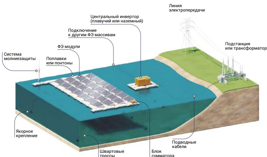
центральный, так и струнный инвертор. Обычно для более крупных электростанций ПФЭ необходимо применять центральный инвертор (-ы) со степенью защиты IP67, устанавливаемый в плавучий кожух (и), тогда как большинство небольших ПФЭ имеют устанавливаемые поблизости наземные струнные инверторы. Для передачи выработанной энергии в ближайшую точку подключения к электросети используются подводные изолированные кабели (данная
