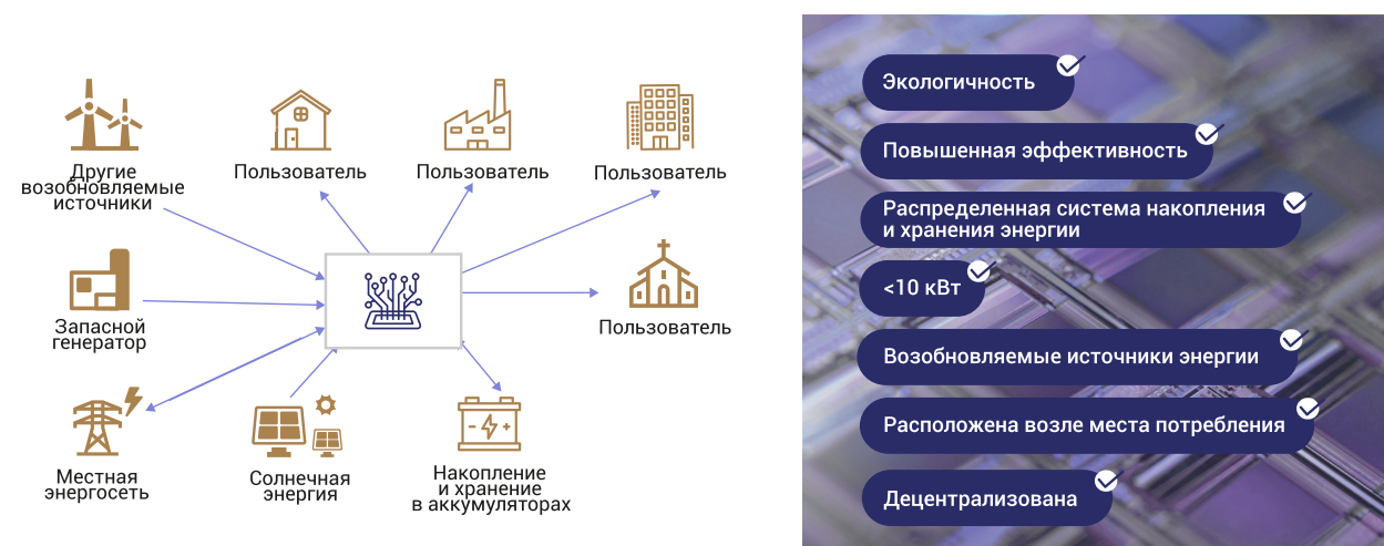
РИСУНОК 6. Схематическое представление микросети и ее основных характеристик
