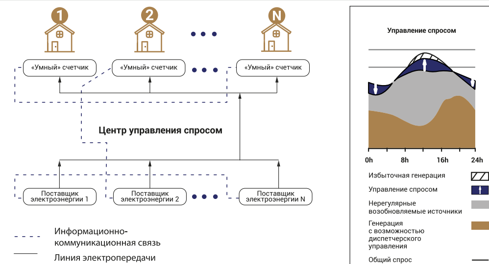
РИСУНОК 3. Схематическое представление управления спросом и его преимуществ
