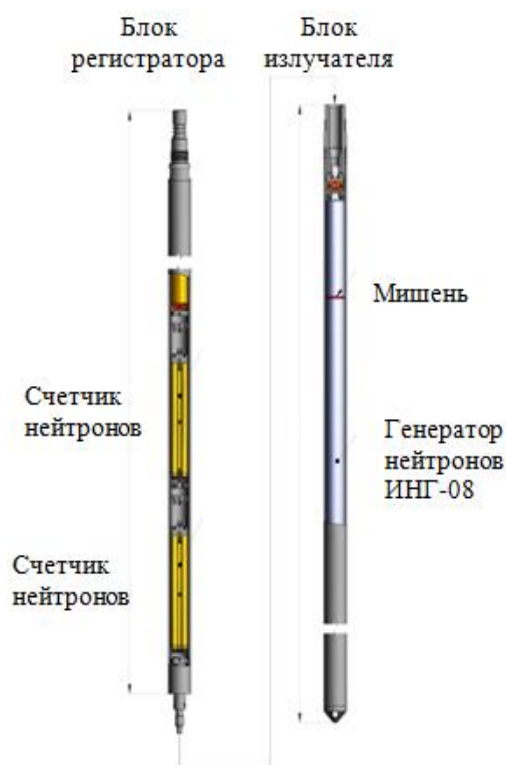
Рис. 1. Конструкция и основные характеристики аппаратуры АИНК-43П.
