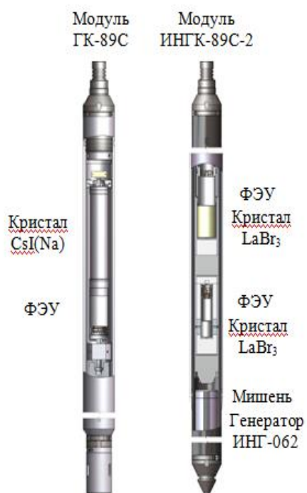
Рис. 3. Конструкция и основные характеристики аппаратуры АИНК-ПЛ
