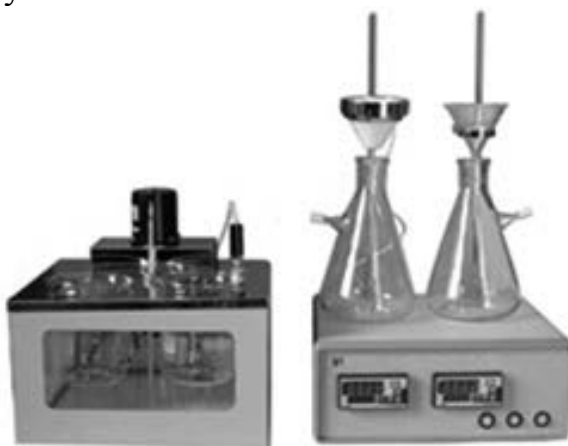
Рис. 2. Аппарат для определения механических примесей МХП-ПХП
