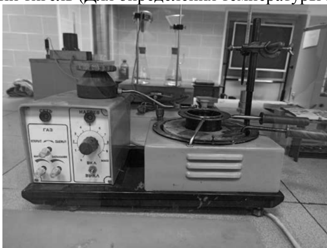
Рис. 3. Аппарат для определения температуры вспышки в открытом тигле ТВЗ
