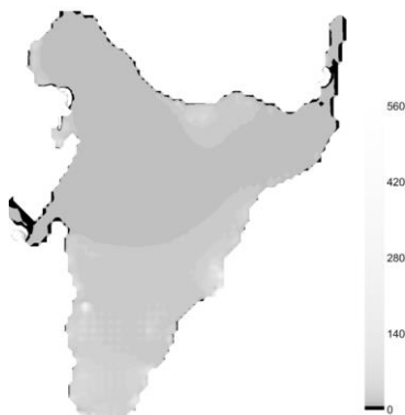
Рис. 3. Поле максимально возможной мутности ( \text{г/м}^3 ) в акватории Сестрорецкого Разлива в меженный период при расходе воды р. Сестра – ст. Белоостров 2 \text{ м}^3/\text{с}
