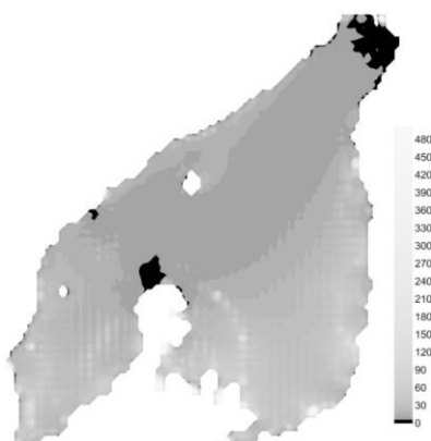
Рис. 2. Поле максимально возможной мутности ( \text{г/м}^3 ) в акватории оз. Неро в меженный период при расходе воды р. Сара – пгт. Петровское 1.7 \text{ м}^3/\text{с}
