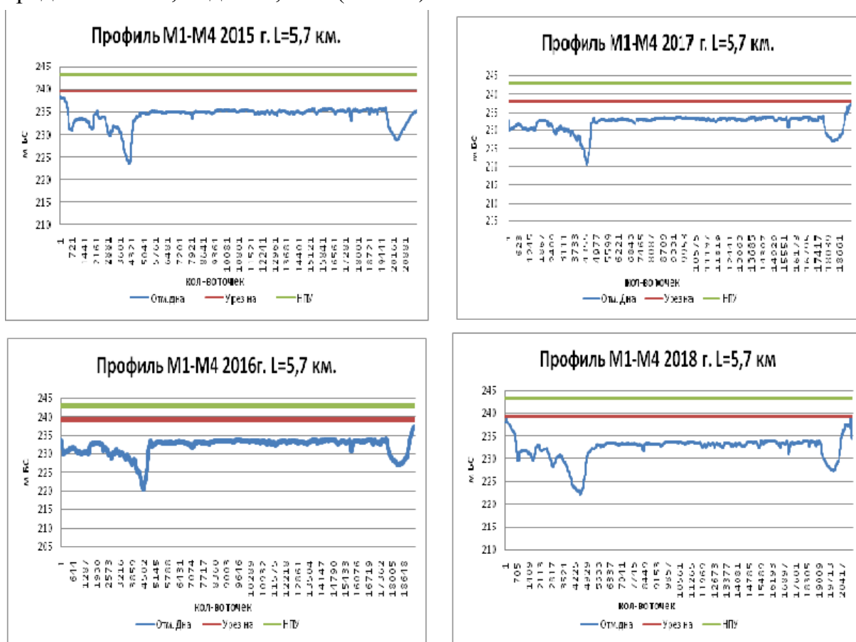
Рис. 4. Изменение рельефа дна по профилю М1-М4 в районе Моховского плёса Красноярского водохранилища за 2015-2018 гг.
