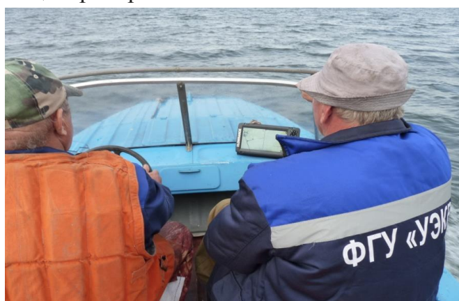
Рис. 2. Батиметрическая съёмка эхолотом-картплоттером LOWRANCE HDS 7 GEN2 в районе Моховского плёса, 09.07.2018 г.
