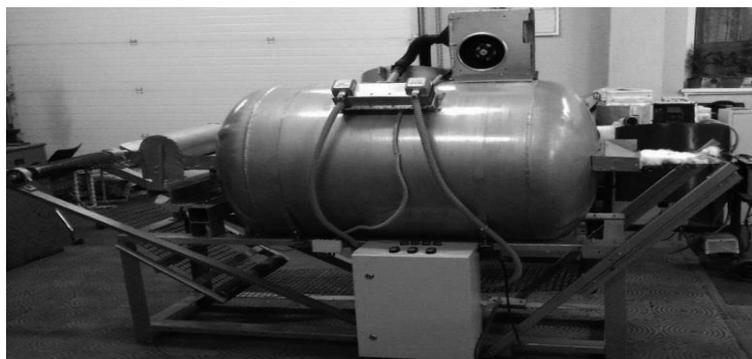
**Рисунок 2. Опытный образец СВЧ установки для сбора пуха от шкурок кроликов**
