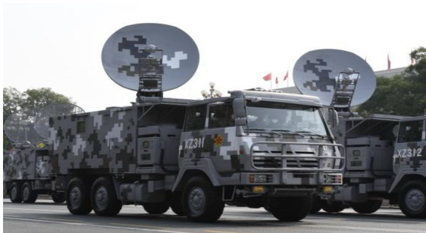
Рис. 17. Станция радиосвязи на базе БТР (тип 07) (сверху), станция спутниковой связи на базе автомобиля «Дунфэн» (снизу) (Источник: Китайский военно-технический журнал «Оружейное знание»)
