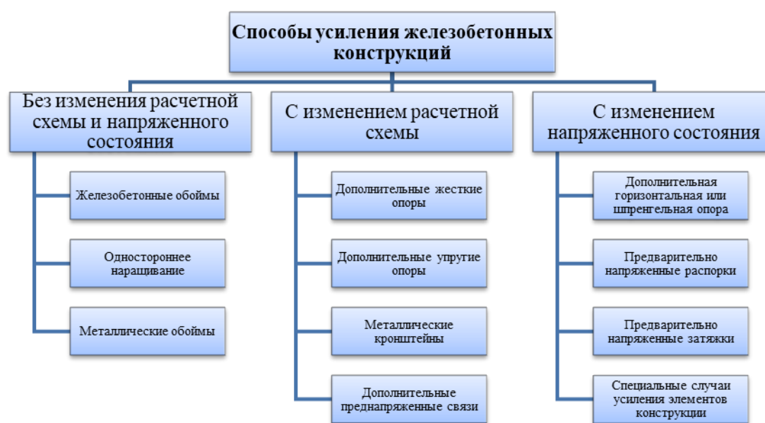
Рис. 3. Способы усиления железобетонных конструкций
