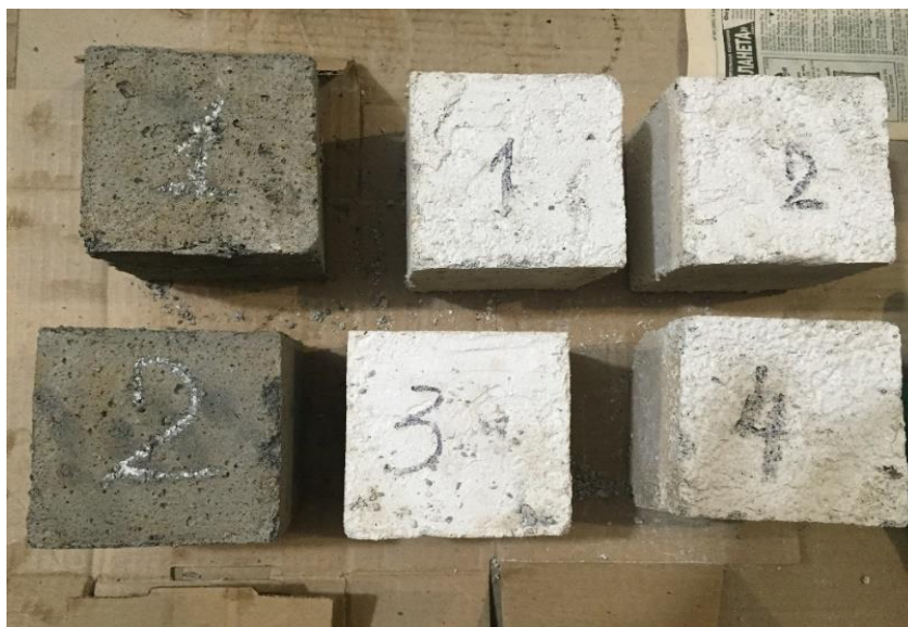
Рис. 2. Кубики 70,7x70,7x70,7 см для определения прочности на сжатие (кубиковая прочность)
