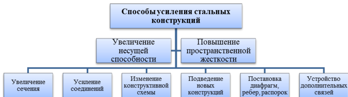
Рис. 4. Способы усиления стальных конструкций
