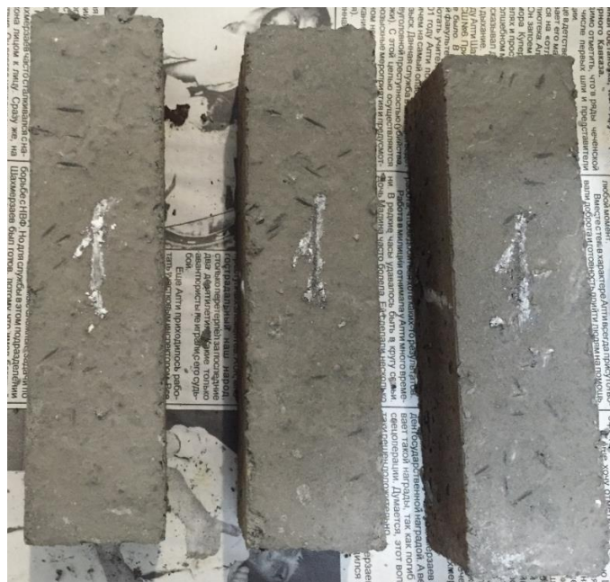
Рис. 3. Балочки 4x4x16 см для определения призмной прочности и прочности на растяжение при изгибе
