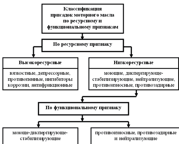
Рис. 1. Структура классификации присадок и их комплексов по функциональному и ресурсному признакам
