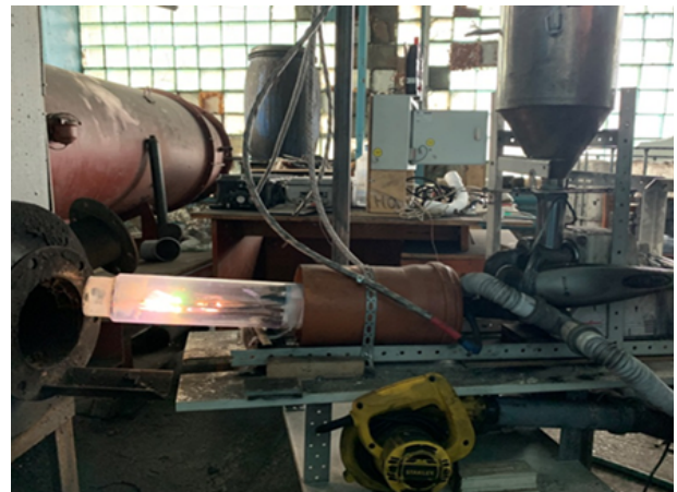
Рис. 1. Рабочий макет вихревой адиабатической вихревой топки с использованием низкотемпературной неравновесной плазмы для стабилизации процесса горения
