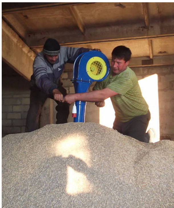
Рис. 1. Склад напольного хранения зерна традиционного типа (показана установка аэратора зерна в месте самосогревания зерна, обнаруженного при ручном измерении температуры зерна с помощью термощупа)
