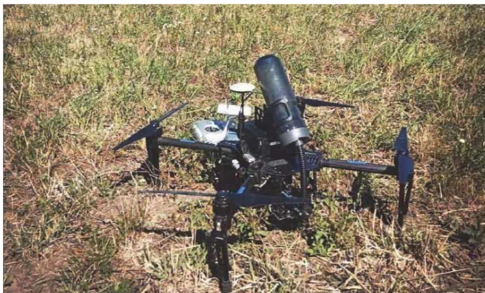
Рисунок 1 - Беспилотный летательный аппарат, оснащенный отсеком для полезных насекомых с дозатором
