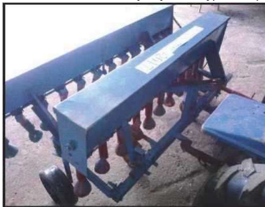
Рис.2. Опытный образец сеялки травосмесей в агрегате с минитрактором Феншоу-180, а) вид сеялки справа;
