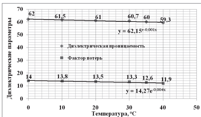
Рисунок 3 – Изменение диэлектрических характеристик коровьего молозива от температуры: 1 – диэлектрическая проницаемость; 2 – фактор диэлектрических потерь
