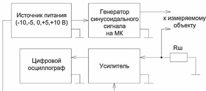
Рисунок 4 – Блок-схема измерительной установки (МК – микроконтроллер, R_{ш} – токовый шунт)
