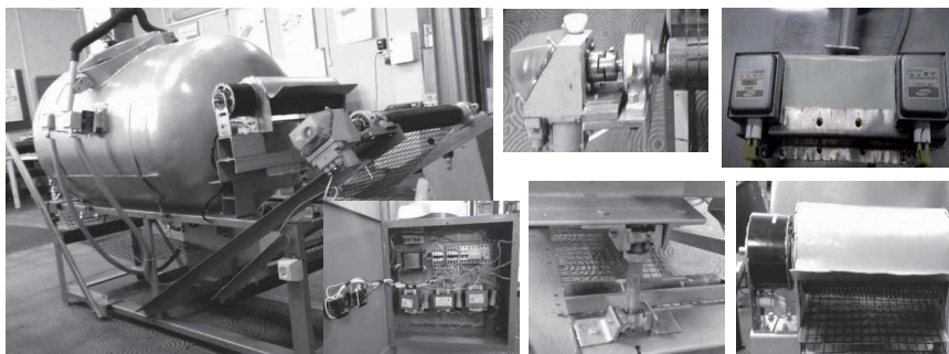
Рисунок 2 – СВЧН установка для отделения волосяного покрова от шкурки кроликов: а) установка; б) шкаф управления; в) электропривод сеточного транспортера; г) магнетроны; д) щеточный барабан; е) механизм регулирования зазора между шкуркой и щеточным барабаном
