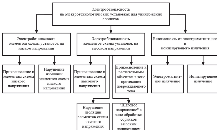
Рисунок 2 – Основные элементы электробезопасности при использовании электротехнологических установок для уничтожения сорняков
