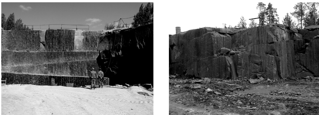
Рис. 4. Основные системы трещин на месторождениях габбродолеритов Восход слева, и Авнепорог справа
