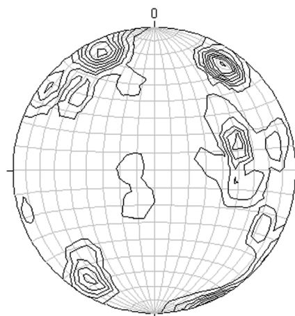
Рис. 5. Основные системы трещин на месторождении гранитов Сиговое (а), и круговая диаграмма трещиноватости (б), (количество замеров 190, равноплощадная проекция, верхняя полусфера)
