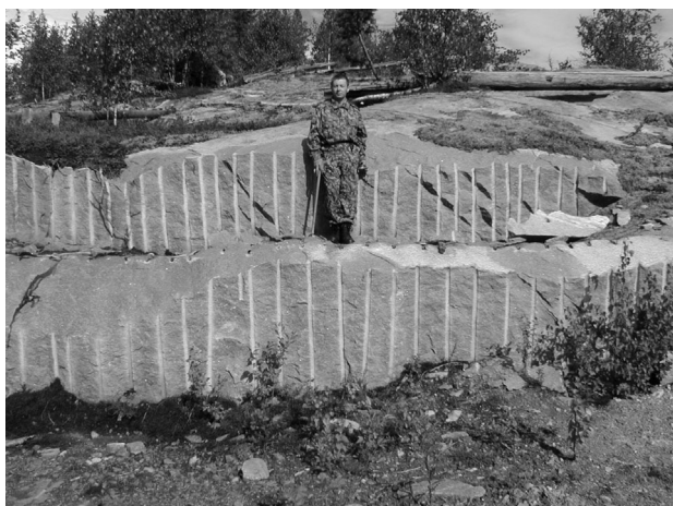
Рис. 5. Основные системы трещин на месторождении гранитов Сиговое (а), и круговая диаграмма трещиноватости (б), (количество замеров 190, равноплощадная проекция, верхняя полусфера)
