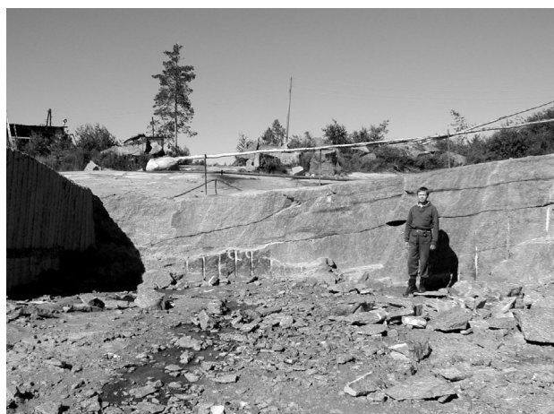
Рис. 3. Основные системы трещин на месторождении гранит мигматитов Кашина Гора (а), и круговая диаграмма трещиноватости (б), (количество замеров 682, равноплощадная проекция, верхняя полусфера)
