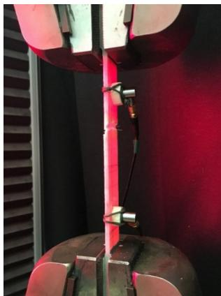
Рис. 1. Образец КМ в захватах испытательной системы с установленными датчиками регистрации сигналов акустической эмиссии
