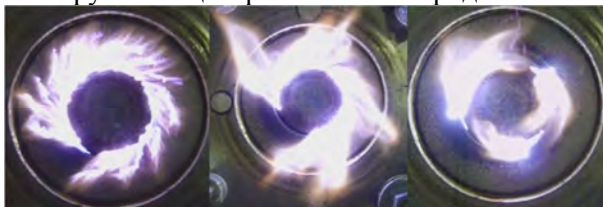
Рис. 12. Фото разряда для геометрии рис.1. з). Вид сверху. Порядок следования слева направо. Поток воздуха: G=80 л/мин, 50 л/мин, 30 л/мин соответственно. Ток I=440 мА. Глубина погружения центрального электрода l=0 мм.
