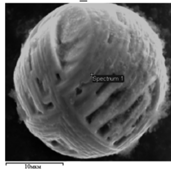
Рис. Сферическое образование диборида титана (размер ~40 мкм)
