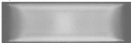
Рис.1. Фотография стационарного БР. Смесь He + Ar (5%), P = 130 Тор, f = 10 кГц.
