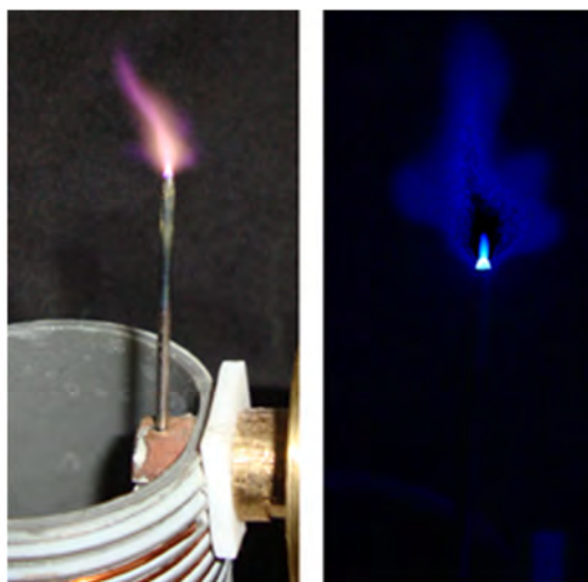
Рис.2. Фотографии факельного разряда. Слева без фильтра, справа с фильтром 391нм.
