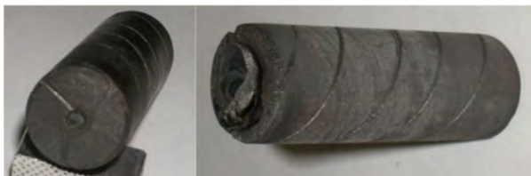
Рис. 2. Фотографии графитовой вставки катода плазматрона до начала работы (слева) и с кратером депозита на торце электрода после окончания работы (справа)
