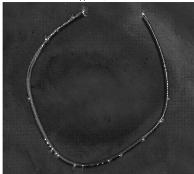
Рис. 2. Медная проволока в ДБР, визуализация проколов изоляции.
