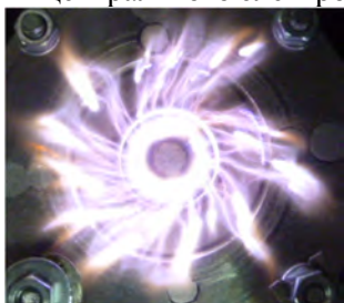
Рис. 11. Фото разряда для геометрии рис.1. в). Вид сверху. Поток воздуха G=80 л/мин. Ток I=320 мА, напряжение U=1100 В. Глубина погружения центрального электрода l=9 мм
