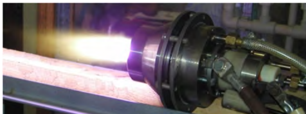
Рис. 1. Выходящий плазматрон постоянного тока.
