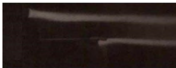
Рис.2 Фотография разряда постоянного тока в сверхскоростном потоке воздуха [3].
