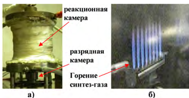
Рис.1. Фотографии экспериментальной установки: реактор для плазменно-каталитического реформирования этанола – (а); горение синтез-газа мощностью 2 кВт на выходе из реактора на стандартных газовых горелках для котлов Navien – (б)
