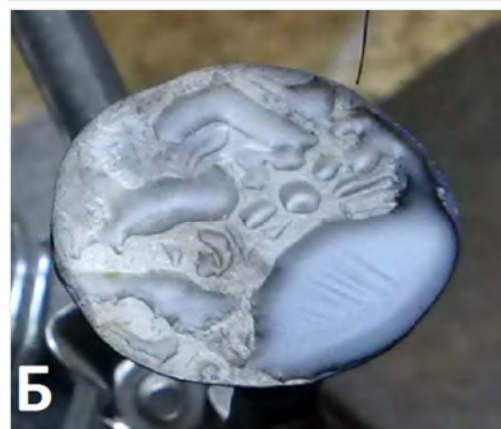
Рис.5. Стеарин, экранированный пластиной: А) во время обработки разрядом; Б) застывший после обработки разрядом.
