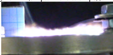
Рис. 10. Фото разряда для геометрии рис.1. в). Вид сбоку. Поток воздуха G=80 л/мин. Ток I=320 мА, напряжение U=1100 В. Глубина погружения центрального электрода l=9 мм
