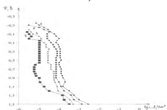
Рис.4. Анодные поляризационные кривые в растворе \text{Na}_2\text{SO}_4+\text{NaOH} , pH 8 (1-сталь 08X18H10T; 2-TiNC-покрытие P(\text{N}_2+\text{C}_2\text{H}_2)=0,8 Па, Q=12 л/ч; 3-TiNC-покрытие P(\text{N}_2+\text{C}_2\text{H}_2)=1,0 Па, Q=20 л/ч; 4-TiNC-покрытие P(\text{N}_2+\text{C}_2\text{H}_2)=1,0 Па, Q=30 л/ч)
