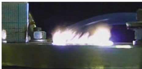
Рис. 8. Фото разряда для геометрии рис.1. в). Вид сбоку. Поток воздуха 80 л/мин. Ток I=300 мА, напряжение U=600 В. Глубина погружения центрального электрода l=0 мм.
