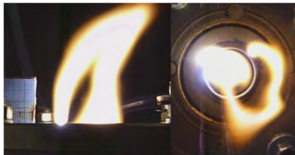
Рис. 13. Фото разряда для геометрии рис.1. з). Вид сбоку и сверху. Порядок следования справа налево. Поток воздуха: G=20 л/мин, I=470 мА, глубина погружения центрального электрода l=5 мм.
