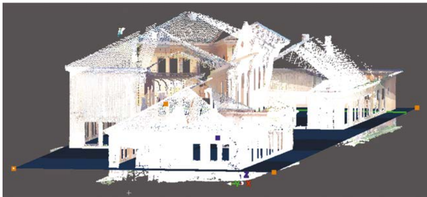
Рис. 3. Модель здания травматологии, полученная методом лазерного сканирования
