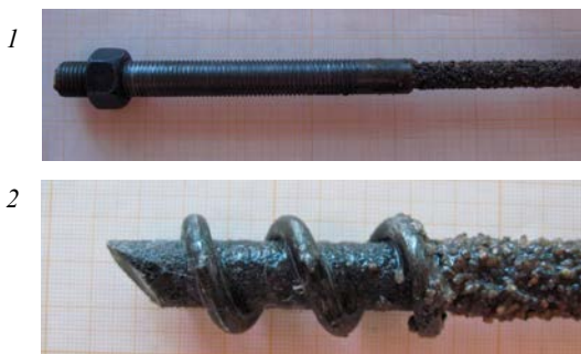
Рис. 1. Композитная анкерная крепь: 1 – стальной хвостовик с гайкой; 2 – размещивающий наконечник
